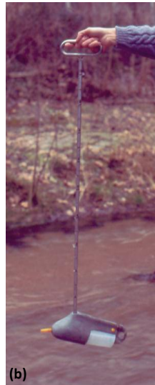
Figura 17 (a) Mostrejador de integració en profunditat US DH48 (dibuix de Sala i Gallart, 1989); (b) Mostrejador manual US DH48; (c) Mostrejador manual US DH74 (versió 30 kg) funcionant des de grua i acoblat a molinet OTT C-32.
