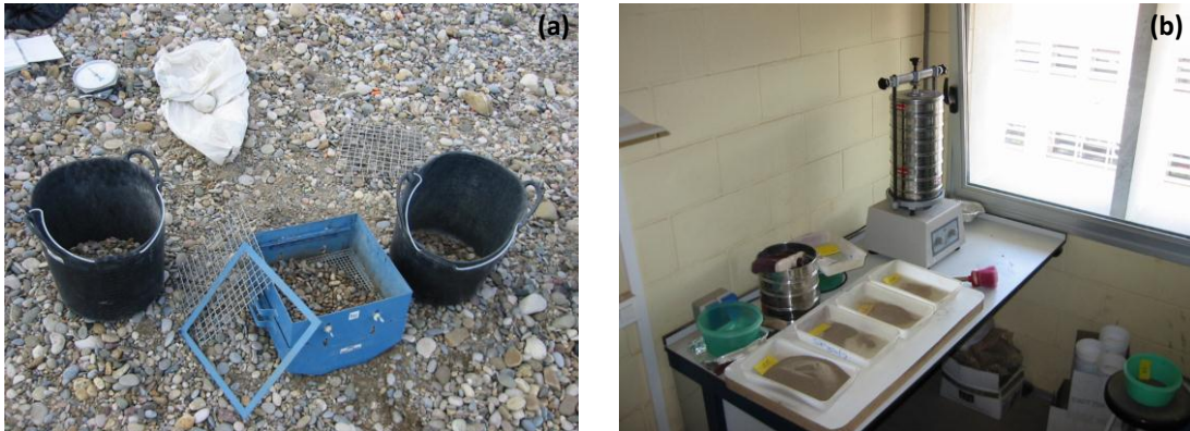
Figura 11. (a) Granulòmetre de camp i (b) Torre granulomètrica de laboratori per al garbellat de mostres de sediments.
