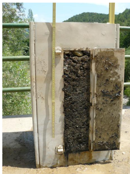
Figura 30. Calaix d'acer d'una de les trapes de l'estació experimental d'Inglabaga, Ribera Salada; a la foto es veu la porta lateral que permet observar l'estratificació del sediment a l'interior del calaix.
