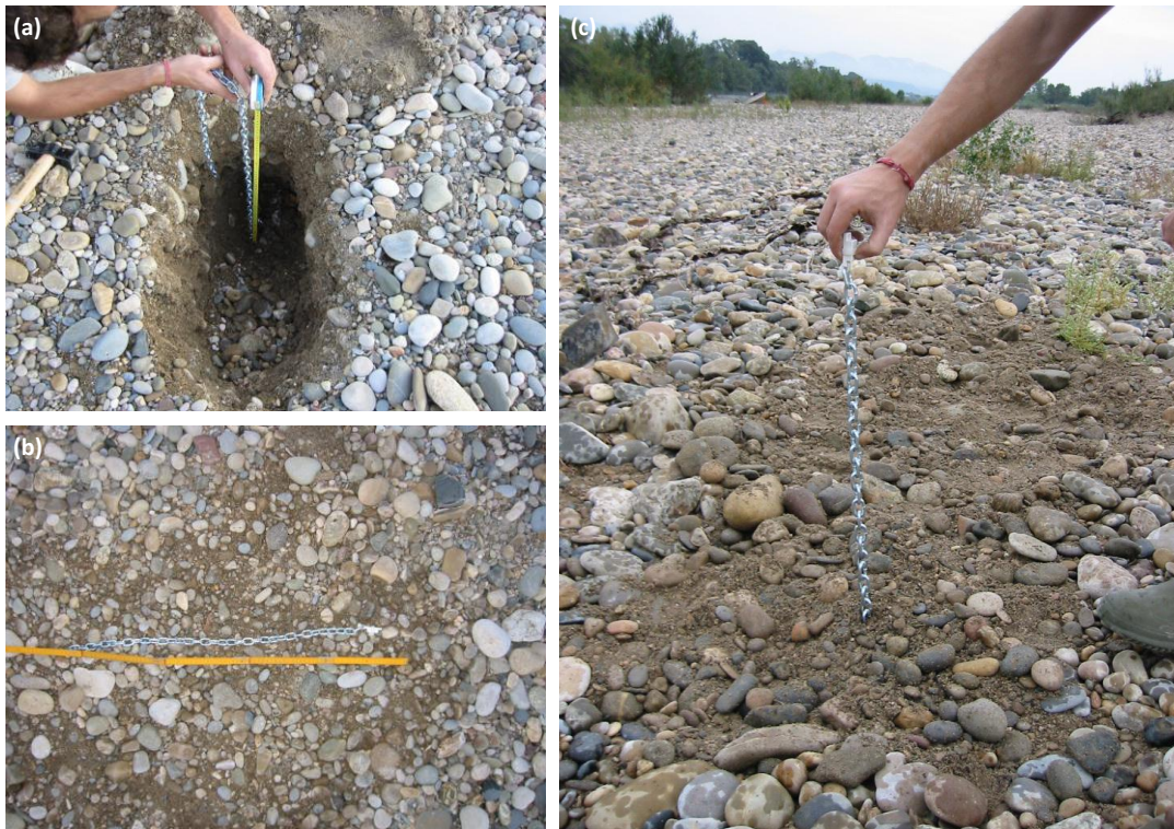
Figura 33. (a) Instal·lació d'una cadena d'erosió al tram baix del riu Ebre. (b) i (c) Cadena d'erosió al tram baix del riu Ebre un cop instal·lada. Els canvis en la longitud de la cadena exposada i/o la presència de material a sobre del tram de cadena exposada abans d'episodis de crecuda permet el càlcul puntual del material erosionat i/o sedimentat (Figura 34). La instal·lació de diverses cadenes en diferents seccions de control permet el càlcul (promig) del gruix de material erosionat i/o sedimentat. L'extrapolació d'aquest valor al conjunt de l'àrea activa de cadascuna de les seccions permet calcular l'àrea erosionada i/o sedimentada. Aquests valors es poden interpolar entre seccions per tal d'extreure el volum de canvi en el tram d'estudi.
