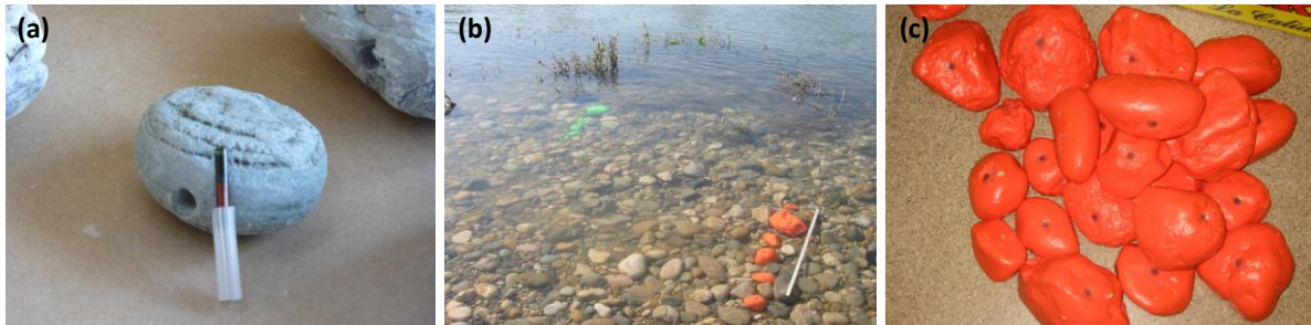
Figura 32. (a) Exemple de traçador amb sistema de radio (RFID). Cada traçador disposa d'un identificador en el que es registren les característiques (incloent codi) de la partícula. Aquests transmissors emeten un senyal. Es poden localitzar mitjançant una antena i un sistema bàsic de lectura RFID. Es poden trobar tot i estar soterrats, la qual cosa facilita l'estudi de la seva dinàmica i.e. trajectòria i posició dintre de l'estructura sedimentària. (b) Traçadors pintats ubicats al tram baix del riu Ebre. Les partícules es mesuren (eixos) i pinten. Després de les crescudes es busquen visualment. (c) Traçadors magnètics. Cadascun dels traçadors té un tros de ferro de dos centímetres al seu interior (veieu cercle negre a cadascuna de les partícules). Es localitzen amb un detector de metalls. Es poden trobar tot i estar soterrats, la qual cosa facilita l'estudi de la seva dinàmica.
