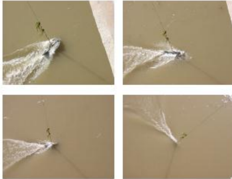
Figura 26. Seqüència fotogràfica durant el mostreig de càrrega de fons: mostrejador de 76 mm de boca d'entrada suspès per cable a la secció de mostreig de Mora d'Ebre, riu Ebre.
