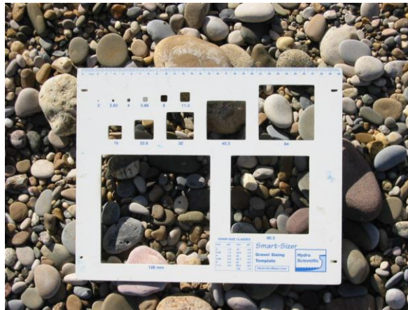
Figura 10. Plantilla granulomètrica dividida en intervals \frac{1}{2} \phi_i ( \phi_i = -\log_2 D_i ).
